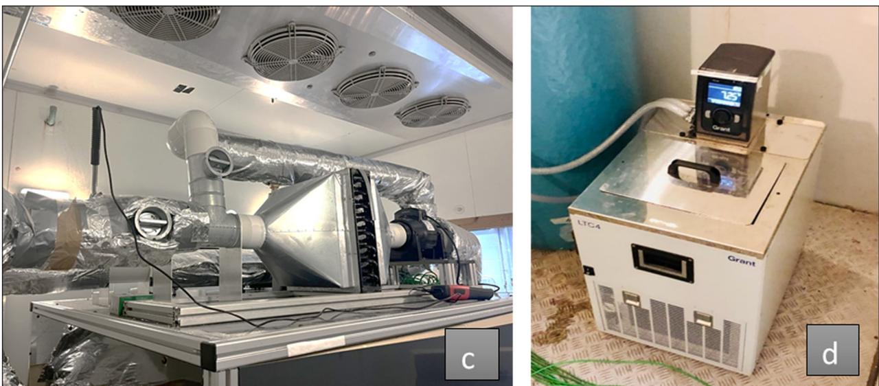
Figure 6 (c) Heat exchanger, (d) Chiller unit.
